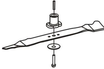
Pour retirer la lame, desserrez la vis, vérifiez le support de la lame et remplacez toutes les pièces si elles sont usées ou endommagées.
