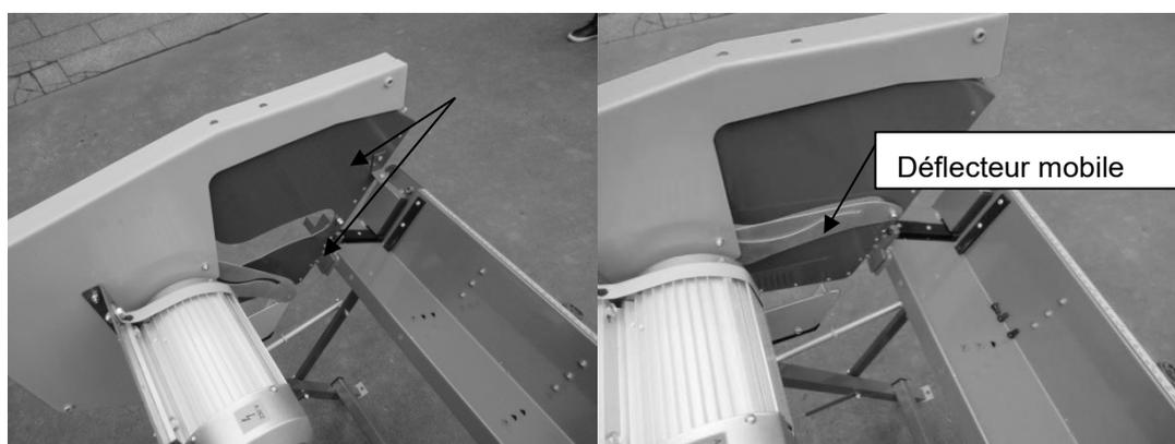
5. Assemblez le couvercle inférieur, utilisez la vis M6X12 pour connecter le couvercle inférieur à la table de travail et utilisez la vis M6X25 pour la fixer.
