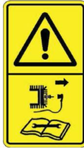
Attention, arrêter le moteur et débrancher le fil de bougie avant de procéder aux opérations de maintenance, de réparation ou de remisage.
