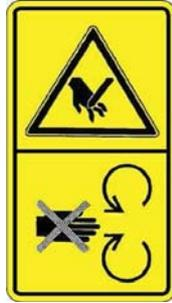
Attention, risque de coupure des doigts ou des mains lors de la manipulation de la lame. Ne pas ouvrir ou retirer les carters de protection tant que la lame tourne.
