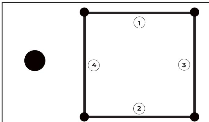
Le receveur doit être parfaitement de niveau sur les 4 portions de prises de mesure.
