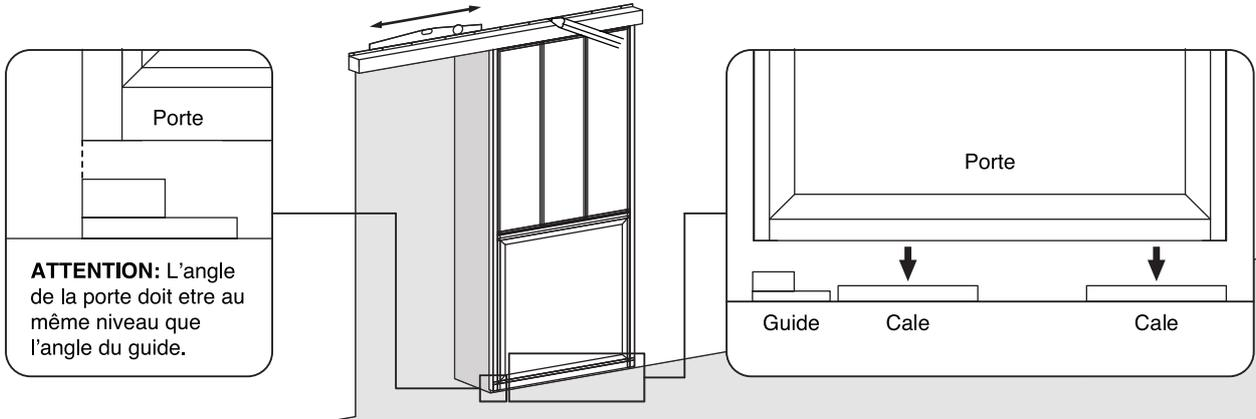
8. Percer et visser le rail au mur (Vis 4,8x60 + cheville + bouchon) ( - 8mm).
