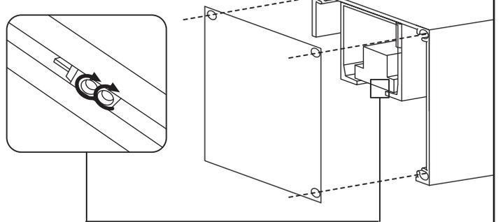
8. Mettre les cales au prolongement du guide, poser la porte sur les cales, le guide devant s'insérer sur la traverse basse de la porte et delimitier l'emplacement pour les fixations (le double chariot doit être clipper sur la butée dans la position de la porte ouverte).
