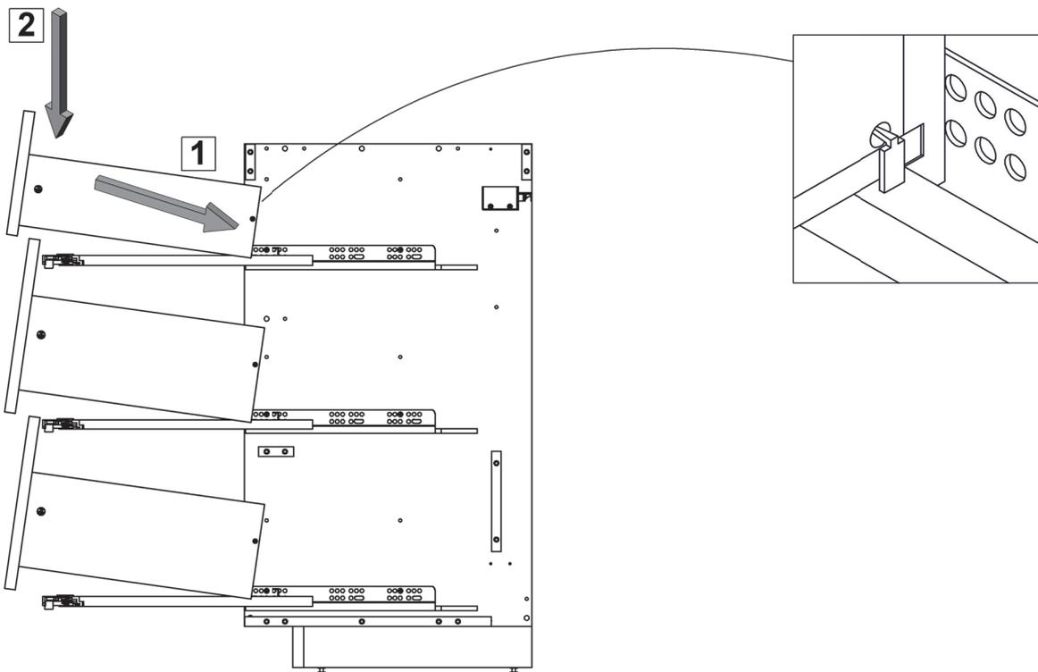
**Fixation anti basculement**
