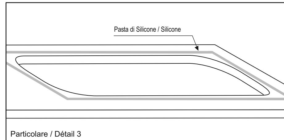
**I** Appoggiare il top (L) già forato per il lavello e per il piano di cottura su due cavalletti o supporti. Applicare la pasta siliconica intorno al foro del lavello. Vedi particolare 3. Mettere i ganci (gl) in dotazione sui bordi del lavello (N). Vedi particolare 4.
