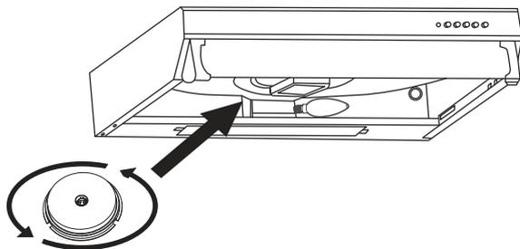
Filtre à charbon, numéro de modèle CARBFILT1, disponible via l'assistance téléphonique (voir la fin de la section Entretien pour plus de détails).
