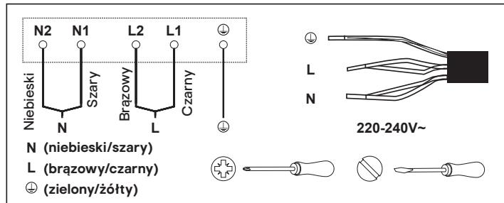
**Urządzenie jest dostarczane z 5-żyłowym przewodem zasilania sieciowego o następujących kolorach:**
