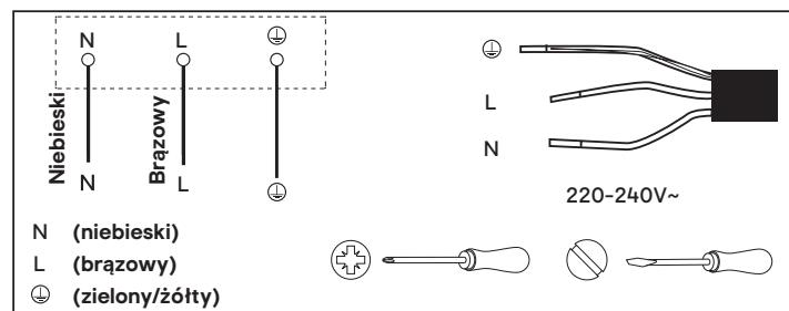
**To urządzenie wymaga wyłącznika różnicowoprądownego (RCD) o wartości 40 A.**
