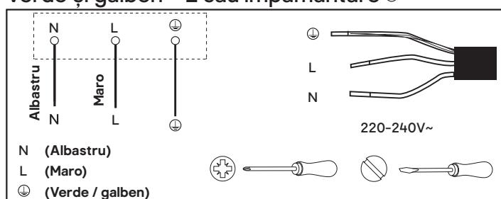
**Aparatul necesită un dispozitiv de protecție la curent rezidual (RCD) de 40 amperi.**
