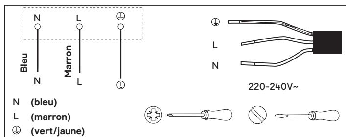
Cet appareil nécessite un dispositif à courant résiduel (RCD) de 40 A.
