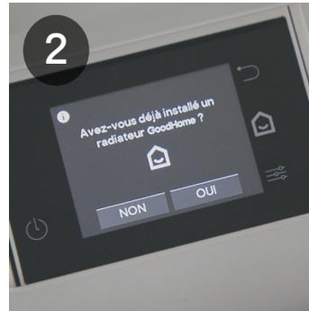
2 Le réseau « Mesh » du radiateur déjà installé est fermé. Votre nouveau radiateur ne peut pas s'y connecter.
