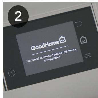
**2** Ce nouveau radiateur détectera automatiquement le 1<sup>er</sup> radiateur installé, grâce au réseau « Mesh ».
