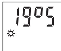
Când este în funcțiune modul Confort (**Con**), apăsați pe butonul + sau - pentru a crește sau a reduce temperatura presetată; temperatura apare intermitent.
