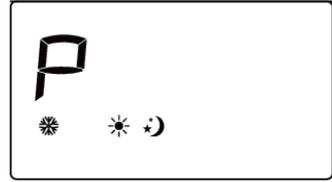
Sous le mode Pilote P, réglez le chauffage à l'aide du programmateur externe.
