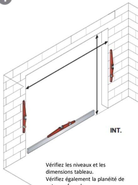
Vérifiez les niveaux et les dimensions tableau. Vérifiez également la planéité de votre surface de pose
