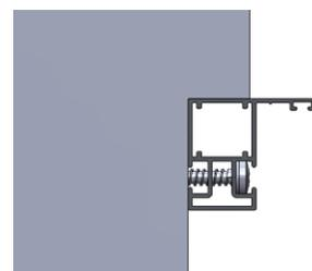
Dans le cas d'une pose en feuillure < 41mm ou d'une pose en tunnel, il faudra réaliser un léger lamage aux endroits où vous fixerez votre bâti à la maçonnerie.
