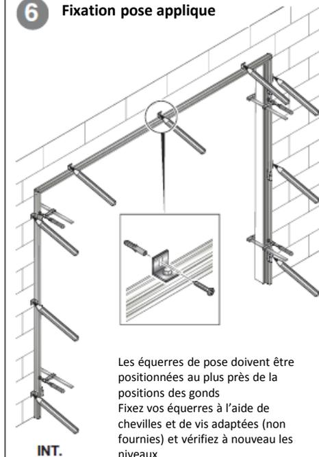
Les équerres de pose doivent être positionnées au plus près de la positions des gonds. Fixez vos équerres à l'aide de chevilles et de vis adaptées (non fournies) et vérifiez à nouveau les niveaux
