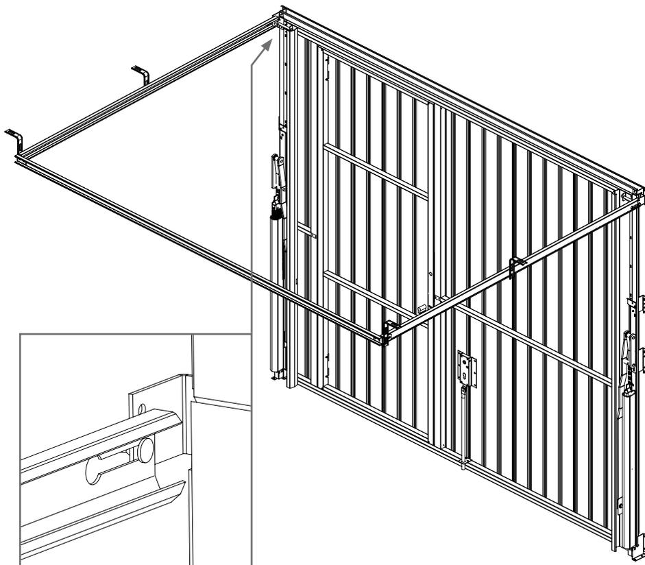
Changer les rails horizontaux de la position B1 à la position B2.
