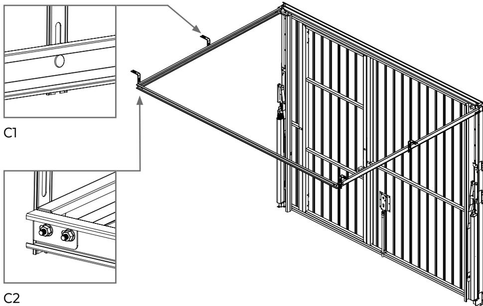
Fixer provisoirement les equerres de fixation des rails horizontaux de fixation au plafond.
