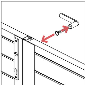
À l'extérieur, insérez la rondelle dans la poignée, puis insérez la poignée dans l'ouverture de la porte.
