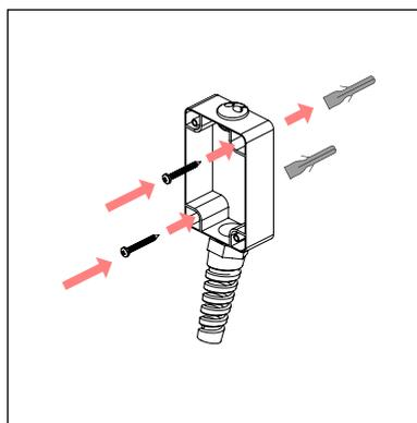
Installez la boîte de connexion suivante sur le mur à la hauteur du panneau supérieur. Voir page suivante.
