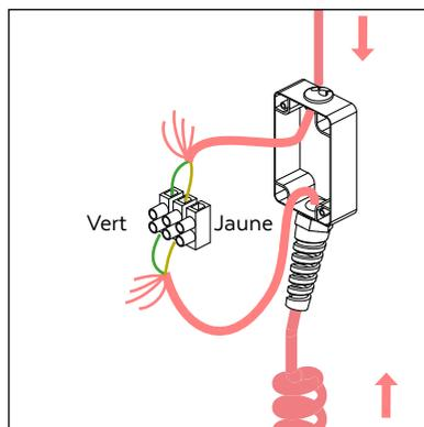
Connectez le câble en spirale au bas de la boîte et l'autre en haut. Connecter les fils vert et jaune
