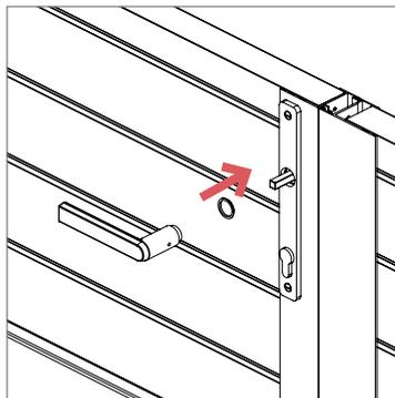
À l'intérieur, insérez la rondelle dans la pièce carrée qui apparaît à travers l'ouverture.
