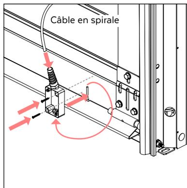
Insérez le câble qui apparaît du profilé inférieur dans la boîte de connexion et installez-le dans le profilé.
