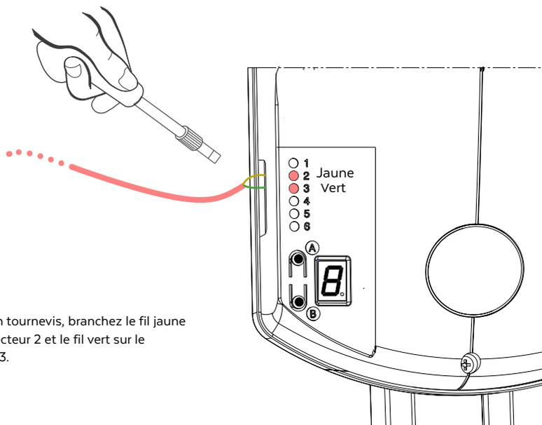
À l'aide d'un tournevis, branchez le fil jaune sur le connecteur 2 et le fil vert sur le connecteur 3.
