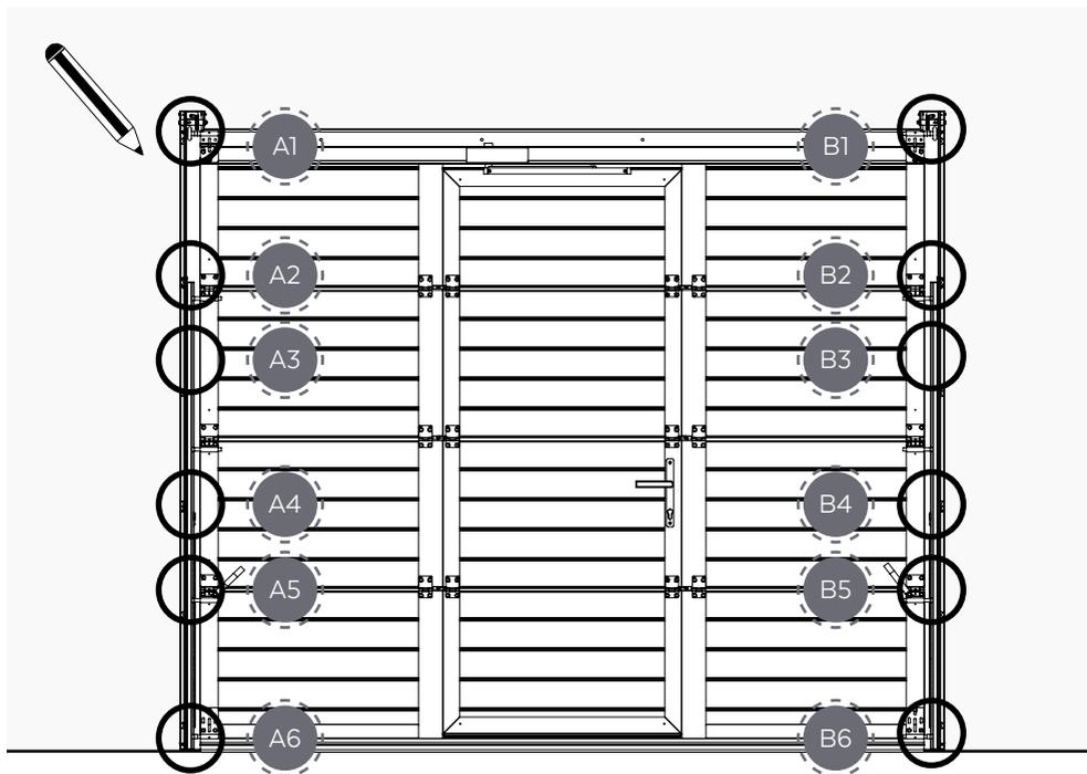
Tracer au crayon l'emplacement des chevilles et des vis qui fixeront le cadre de la porte à la maçonnerie. Puis percer et installer chevilles et vis.
