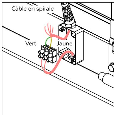
Connectez les câbles inférieurs et les fils jaune et vert du câble spiralé à la barrette de connexion.
