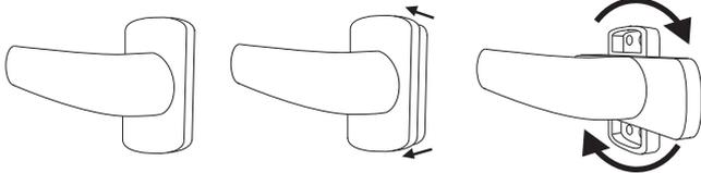
2. Placer la poignée et la rosace sur la porte afin de marquer à l'aide d'un crayon les emplacements pour les vis, puis percer avec un foret adapté (diamètre 3mm). Faites de même de l'autre côté de la porte.
