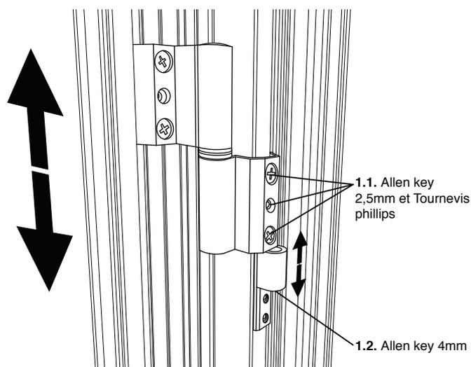
**ATTENTION:** Pour bon réglage vérifier que entre le ouvrant et le cadre fixe nous devons avoir un espacement de 5mm lateral supérieur et 8mm en bas de la porte du sol.
