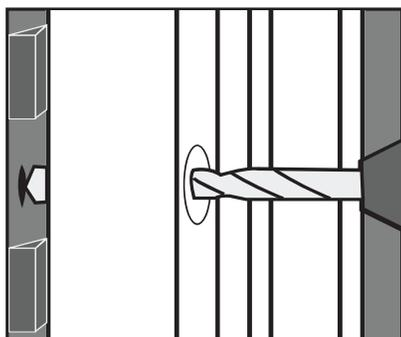
Le trou doit être percé avec un foret de 6 mm de diamètre.
