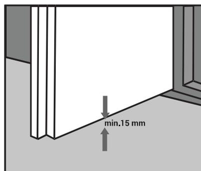
Le vantail doit être à minimum 15 mm du sol
