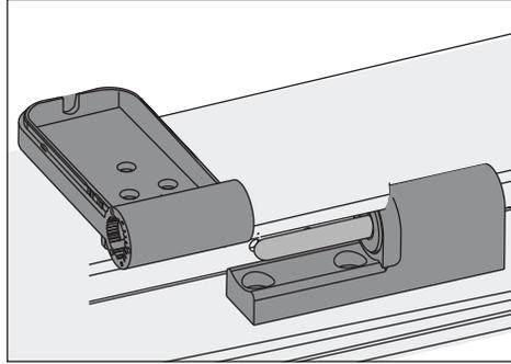
Insérez la charnière du vantail aux galets en faisant des mouvements légers de rotation. Assurez-vous que la pièce dentelée se positionne correctement.
