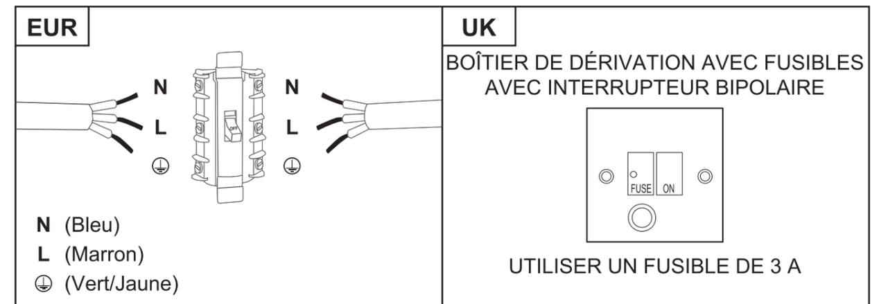
**Cet appareil nécessite un disjoncteur miniature de 3 A.**
