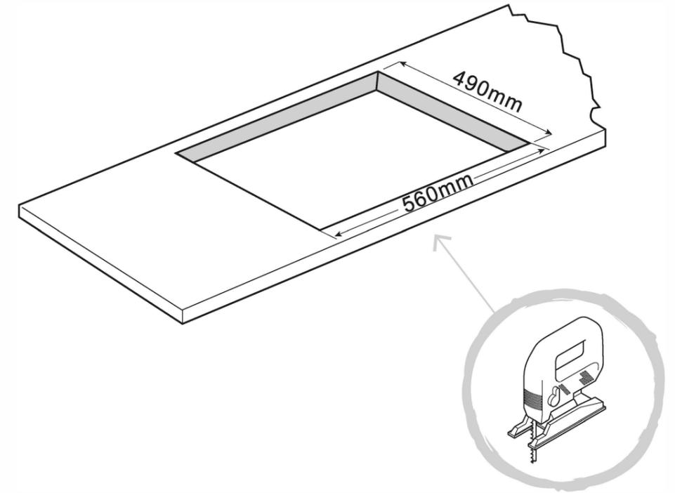
**FR** Découpez une ouverture dans le plan de travail à l'aide d'une scie sauteuse, comme indiqué. Le plan de travail doit être d'au moins 30 mm d'épaisseur et être fabriqué à partir d'un matériau résistant à la chaleur.
