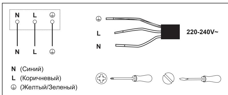
**Для данного прибора требуется 16-амперный малогабаритный автоматический выключатель.**
