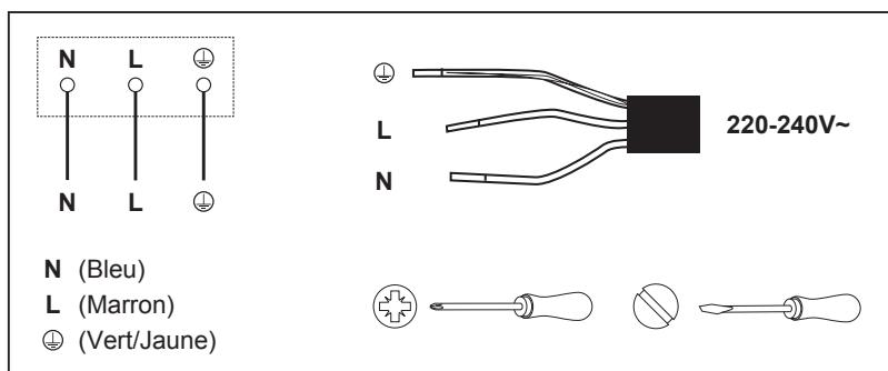
**Cet appareil nécessite un disjoncteur miniature de 16 A.**
