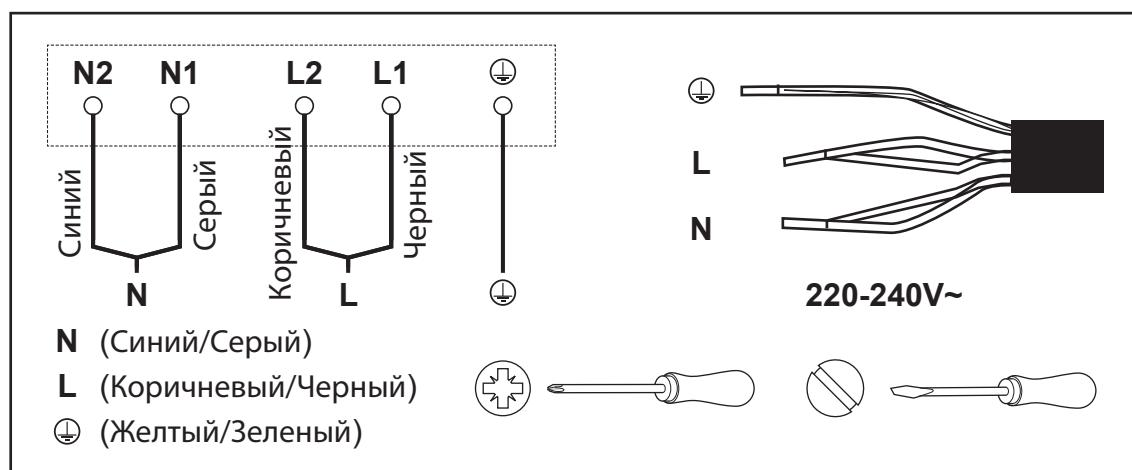
**Для данного прибора требуется 32-амперный малогабаритный автоматический выключатель.**
