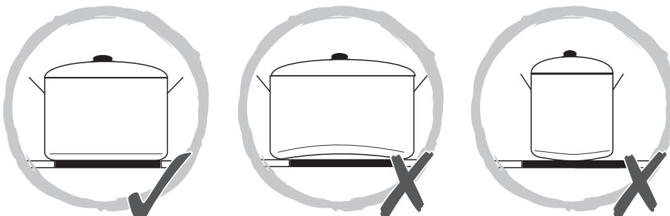
Kaplarınızın tabanlarının pürüzsüz olmasına, camın üzerine düz bir biçimde yerleşmesine ve pişirme alanıyla aynı büyüklükte olmasına dikkat edin. Seçili pişirme alanının işaretileyi aynı çapta olan tavaları kullanın. Tava ve pişirme alanı ölçülerinin birbirine uygun olmasını sağlayarak ve tavayı pişirme alanın merkezine yerleştirerek maksimum etki elde edersiniz. 14 cm'den küçük tavalar algılanamayabilir.
