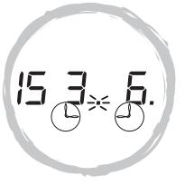
2. Au fur et à mesure que le temps de chaque zone s'écoule, l'affichage s'adapte pour indiquer le prochain temps le plus court, et ainsi de suite.
