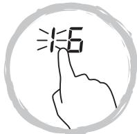
5. Régler les dizaines des minutes en touchant la commande à curseur (par exemple, 9), la minuterie est réglée sur 96 minutes.
