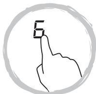
2. Berühren Sie die Boost-Taste
