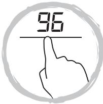
6. Der Countdown des Timers beginnt, sobald die Einstellung der Dauer abgeschlossen ist. Die verbleibende Zeit wird in der Anzeige angezeigt, die Timer-Anzeige blinkt 5 Sekunden lang neben der ausgewählten Kochstelle und bleibt dann eingeschaltet.
