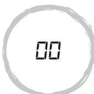
7. Pişirme zamanlayıcısının süresi dolduğunda ilgili pişirme alanı otomatik olarak kapatılır.
