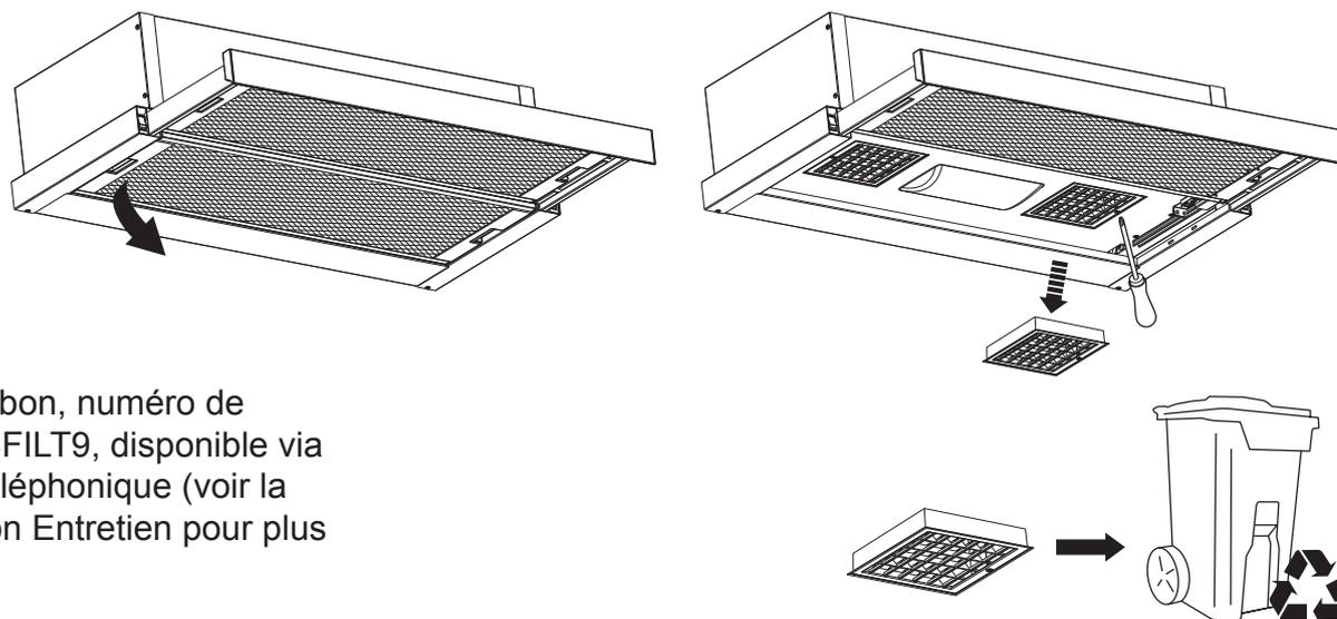
2 filtres à charbon, numéro de modèle CARBFILT9, disponible via l'assistance téléphonique (voir la fin de la section Entretien pour plus de détails).
