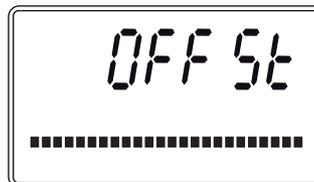
Par exemple, si le radiateur est réglé à 20°C et si le thermomètre ambiant affiche 18°C, le réglage offset doit être de -2°C.
