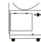
Откройте центральный винт и снимите крышку над емкостью для воды.
