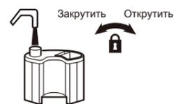
Откройте крышку емкости для воды, заполните емкость на 50 % водопроводной водой и на 50 % — деминерализованной водой, чтобы снизить воздействие минеральных отложений.
