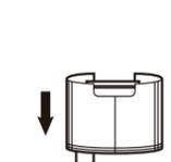
Завинтите крышку на место, вставьте емкость для воды обратно в вентилятор, закрепите винтами крышку над емкостью.
