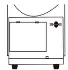
Dévisser la vis centrale et retirer la trappe masquant le réservoir
