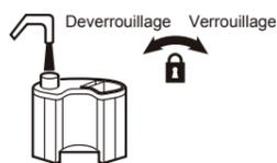
Dévisser le bouchon du réservoir, et ajouter 50 % d'eau du robinet et 50 % d'eau déminéralisée pour minimiser l'impact du tartre
