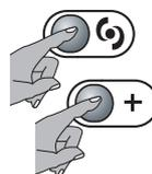
Pour activer la fonction, appuyer simultanément sur les touches "G" et "+" et les maintenir enfoncées jusqu'à ce que l'écran affiche "LEd OFF".
