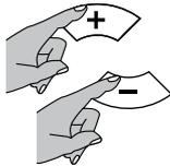
Sélectionner la température désirée à l'aide des touches "+" et "-".
