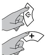
Pour activer la fonction appuyer simultanément sur les touches "Mode" et "+" en les maintenant enfoncées jusqu'à ce que l'icône
