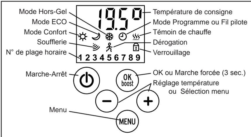
*L'icône et la valeur en cours de réglage clignotent. Le clignotement s'arrête quand le réglage est validé par la touche **OK-forcée**, ou après 30 secondes d'inaction (la modification du réglage est alors annulée).*
