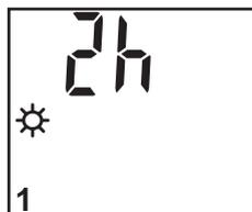
*En mode de fonctionnement Confort, la durée est réglable par pas d'une heure. En mode de fonctionnement Forcé et Soufflerie, la durée est réglable de 5 minutes à 2 heures maximum.*
