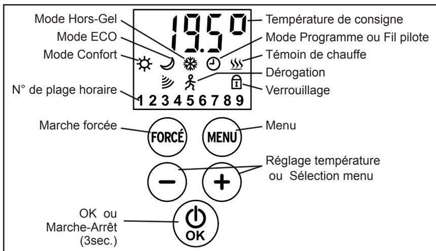
L'icône et la valeur de la fonction en cours de réglage clignotent. Le clignotement s'arrête quand le réglage est validé par la touche /OK, ou après 30 secondes d'inaction (la modification du réglage est alors annulée).
