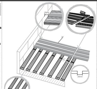
Space suitable for composite or wooden joists - Espacement valable pour lambourdes en composite ou en bois - Przestrzeń przeznaczona do kantowek kompozytowych lub drewnianych - дистанция для крепления балок из композитного материала или дерева - расстояние для крепления деревянных балок - espacio válido para listones de composite o de madera - Espaço aceitável para vigas compósito ou madeira - Komposit veya ahşap travers için gerekli alan - Geeignete Platz für WPC- oder Holzbalkenlage
