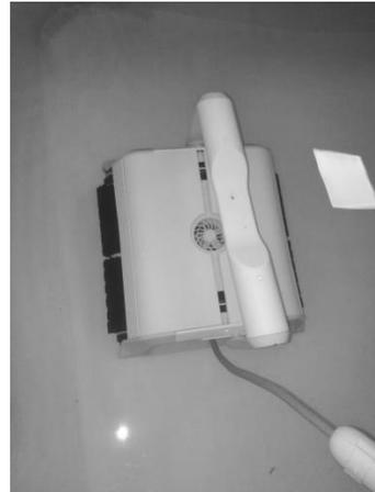
2. Utilisez la poignée pour sortir l'appareil de l'eau, et non pas le câble.
