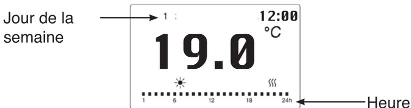
2.Appuyer sur la touche **PRG** à nouveau, appuyer sur **^** pour choisir l'heure, sur **v** pour choisir le mode de chauffage (confort) pour chacune des 24 heures.
