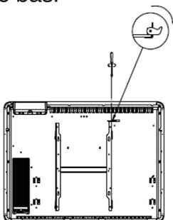
2-Positionner le support mural à l'endroit voulu. S'assurer au niveau à bulle qu'il est horizontal. Marquer l'emplacement des 4 vis de fixation au mur. Percer le mur pour fixer le système d'ancrage adapté. Fixer le support au mur.
