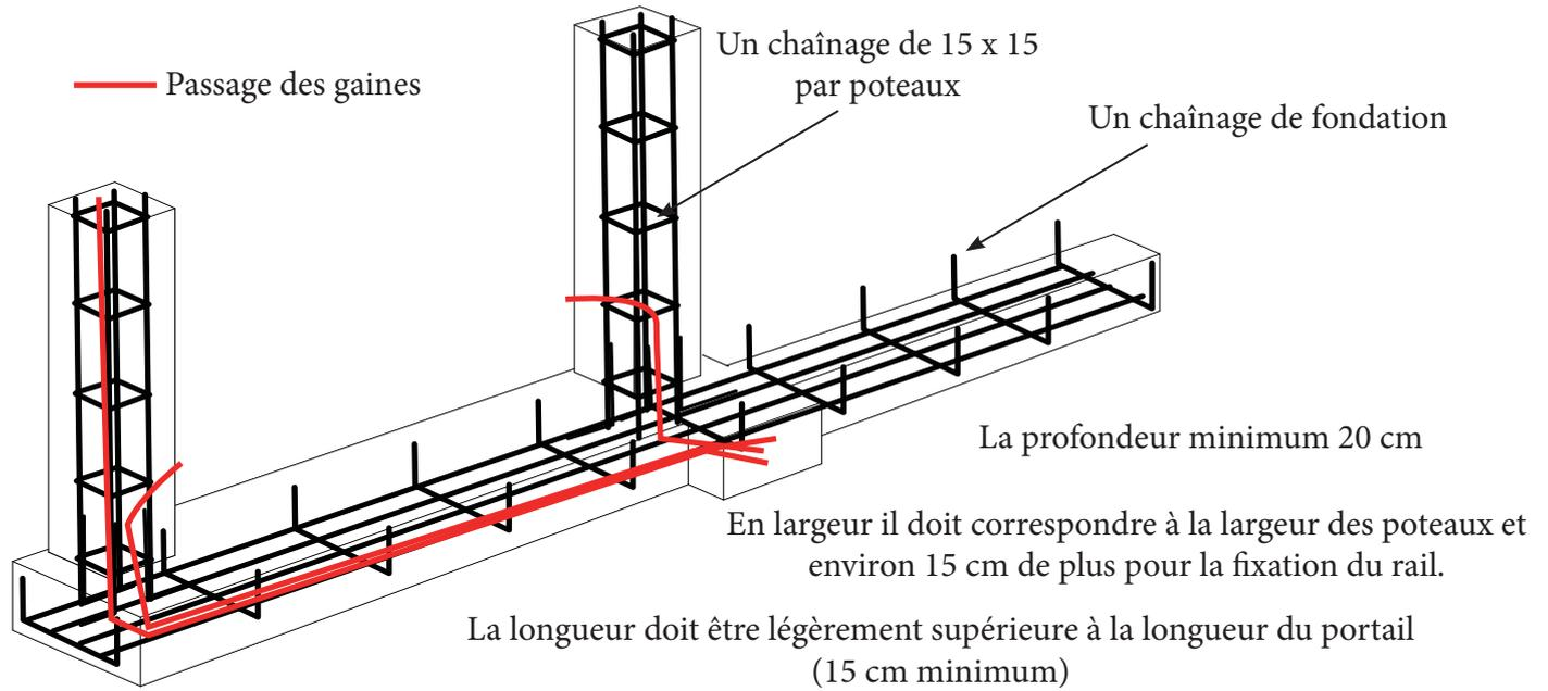
Réaliser une plate forme à la base du poteau du coté du refoulement pour l'emplacement du moteur (30 cm x 30 cm) avec la sortie des gaines.
