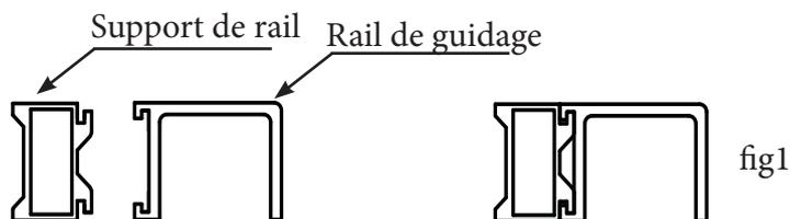
2- Faites coulisser le rail de guidage jusqu'à l'extrémité du montant opposé au côté de refoulement. Le déport du rail de guidage étant de 200 mm du côté du refoulement. Ce déport permet le maintien du portail en place.
