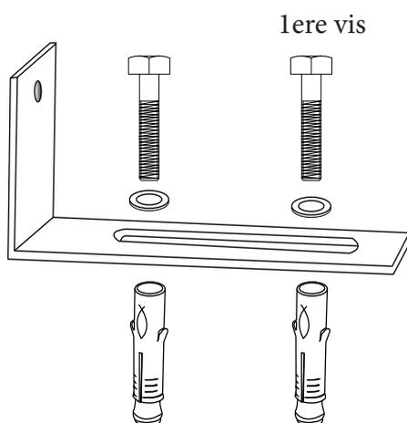
Ouvrir le portail vérifier le contact avec la butée avant de percer pour la deuxième fixation.
