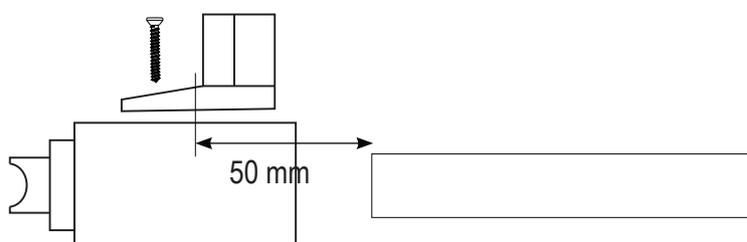
3 - Installez la crémaillère sur le portail avec des vis autoforeuses, installer au centre de la patte de fixation, cela vous permet de pouvoir réaliser un réglage de hauteur par la suite.
