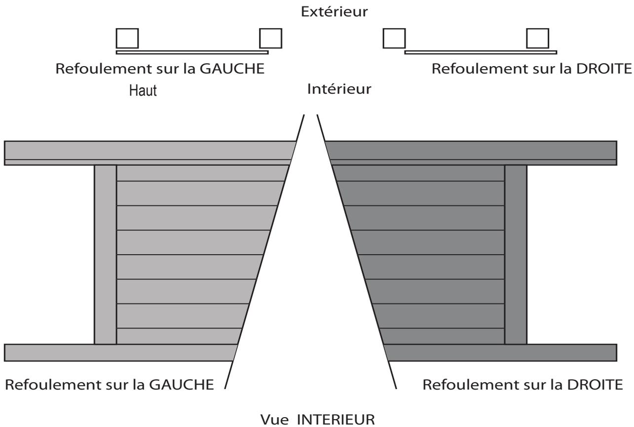
2 - Positionnement du rail de guidage sur la traverse haute
