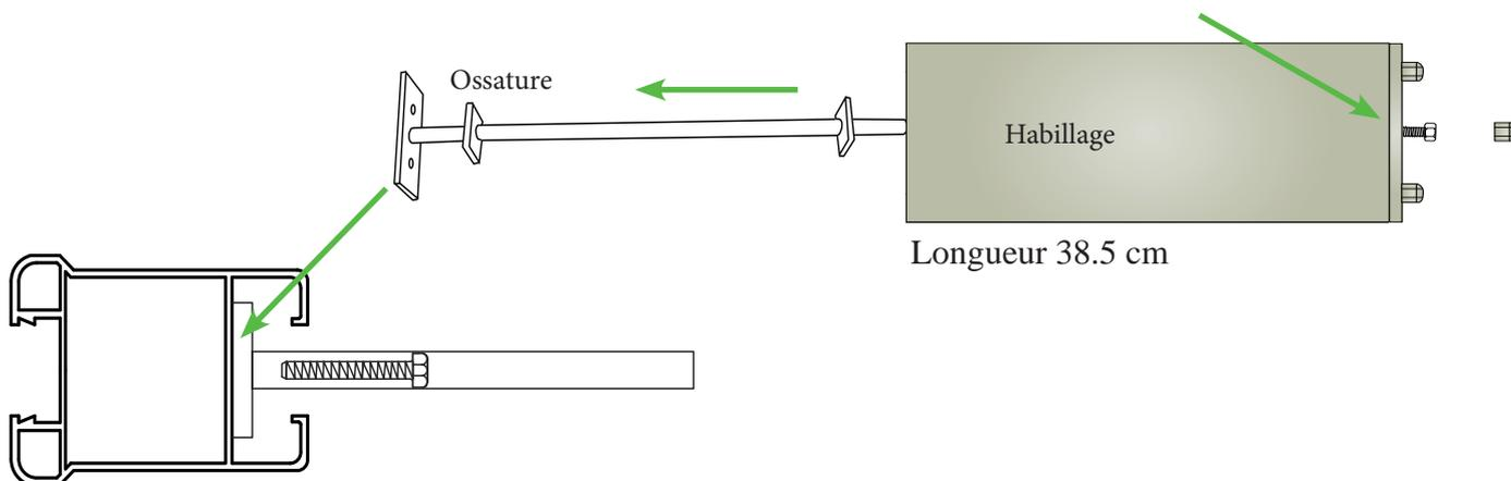
6 - Installer l'ossature métallique avec les vis au même endroit que la contre plaque. Replacer l'habillage sur l'ossature et réinstaller la vis de serrage.
