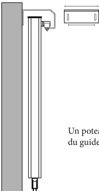
Pour la fixation du chariot guide les piliers doivent être d'une hauteur supérieure au portail de 150 mm.
