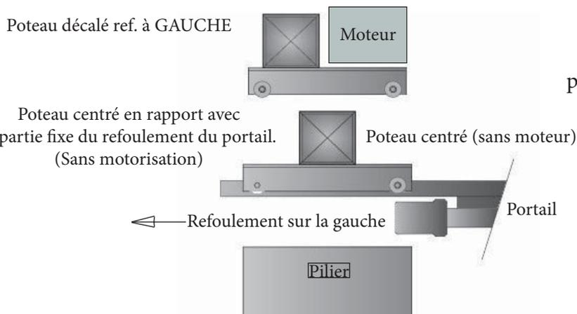
Un poteau guide supplémentaire peut être livré avec le portail. il doit être installé à environs 1.00 mètre du pilier dans le refoulement, il servira de double maintien du couissant lors de son ouverture (Option payante).
