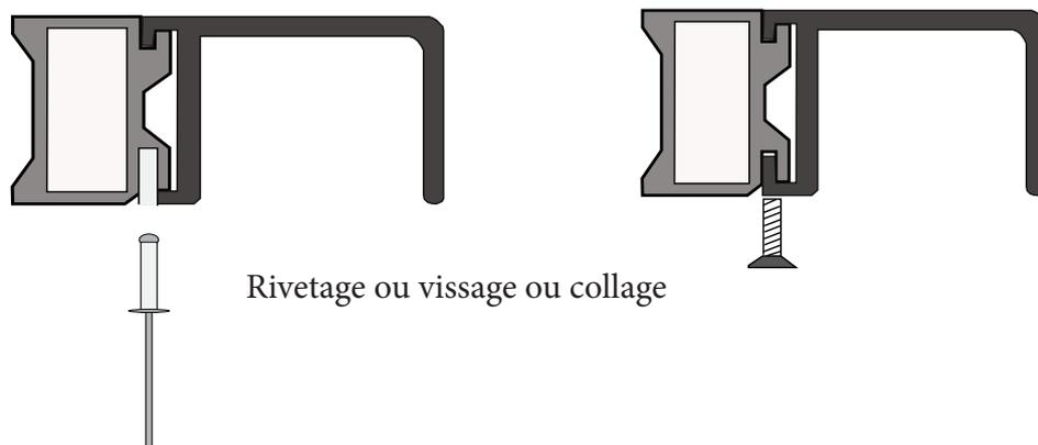
**Ce type de portail nécessite la mise en place d'un support pour l'installation de la crémaillère**
