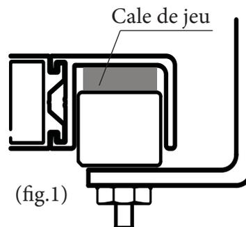
2 - Insérez une cale de 5 mm entre le dessus des roulettes et l'intérieur du guide.
