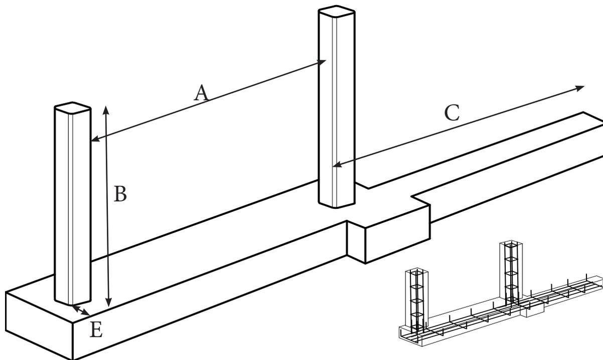
A - Dimension au plus étroit ou dimension tableau, le portail est réalisé plus grand de 6 cm pour venir en recouvrement des piliers de 3 cm de part et d'autre. Pour la commande seule la dimension au plus étroit doit nous être transmise
