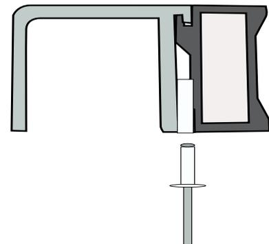
5 - Percer et installer un rivet pour maintenir le guide solidaire au support ou utiliser une colle pour le métal bi-composante époxy.
