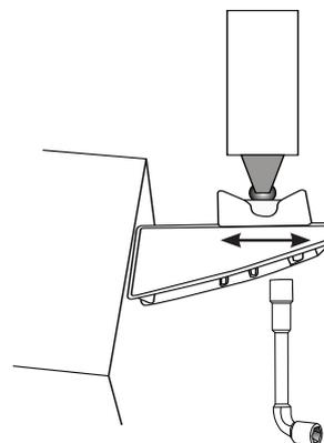
Procédez au réglage de l'aplomb du portail et resserrer les vis avec une clef à pipe de 13
