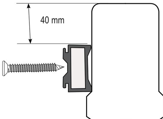
3 - Installer les vis dans les orifices déjà réalisés sur le support et vissez sur la traverse haute
