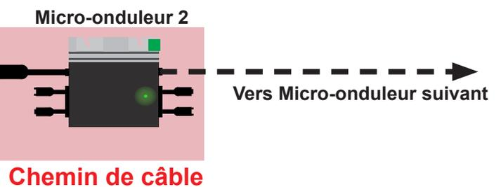
Utilisez, si nécessaire, les rallonges MC4 1m pour le câblage des panneaux PV sur le micro onduleur. Les Micro-onduleurs se connectent sans rallonge.
