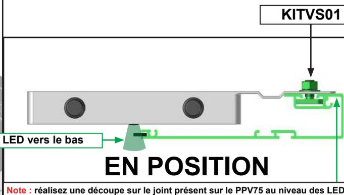
**Note :** réalisez une découpe sur le joint présent sur le PPV75 au niveau des LED
