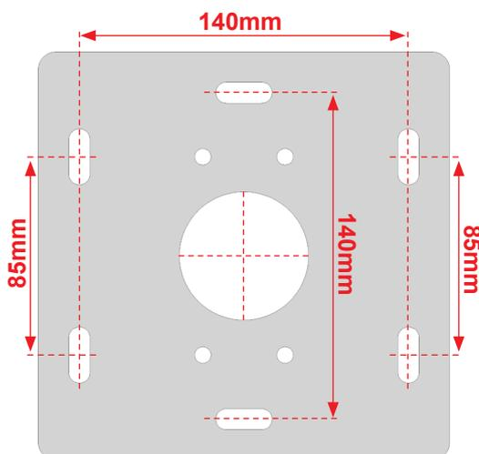
Fixez les platines au niveau de chaque plot béton réalisé auparavant par deux vis minimum.
