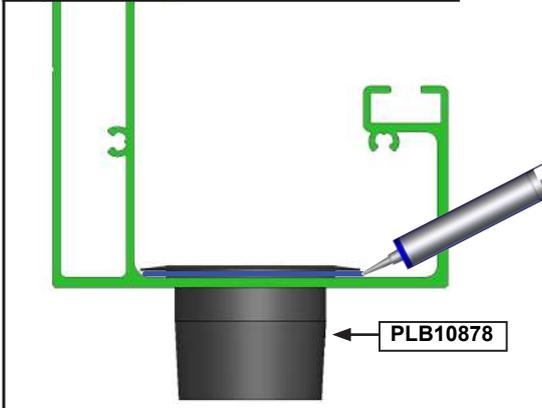
**C** Guider le tube PVC sur la bague.
