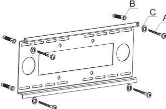
Percez quatre trous d'une profondeur de 50 mm dans le mur. Utiliser une mèche de 10 mm. Vérifier le niveau avec le niveau à bulles. Insérer les chevilles dans les trous percés, puis visser la plaque murale (sur les metalstuds...) dans le mur.
