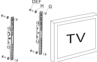
Utiliser les vis cruciformes, la rondelle H et l'entretoise G pour fixer l'écran sur les barres en aluminium.
