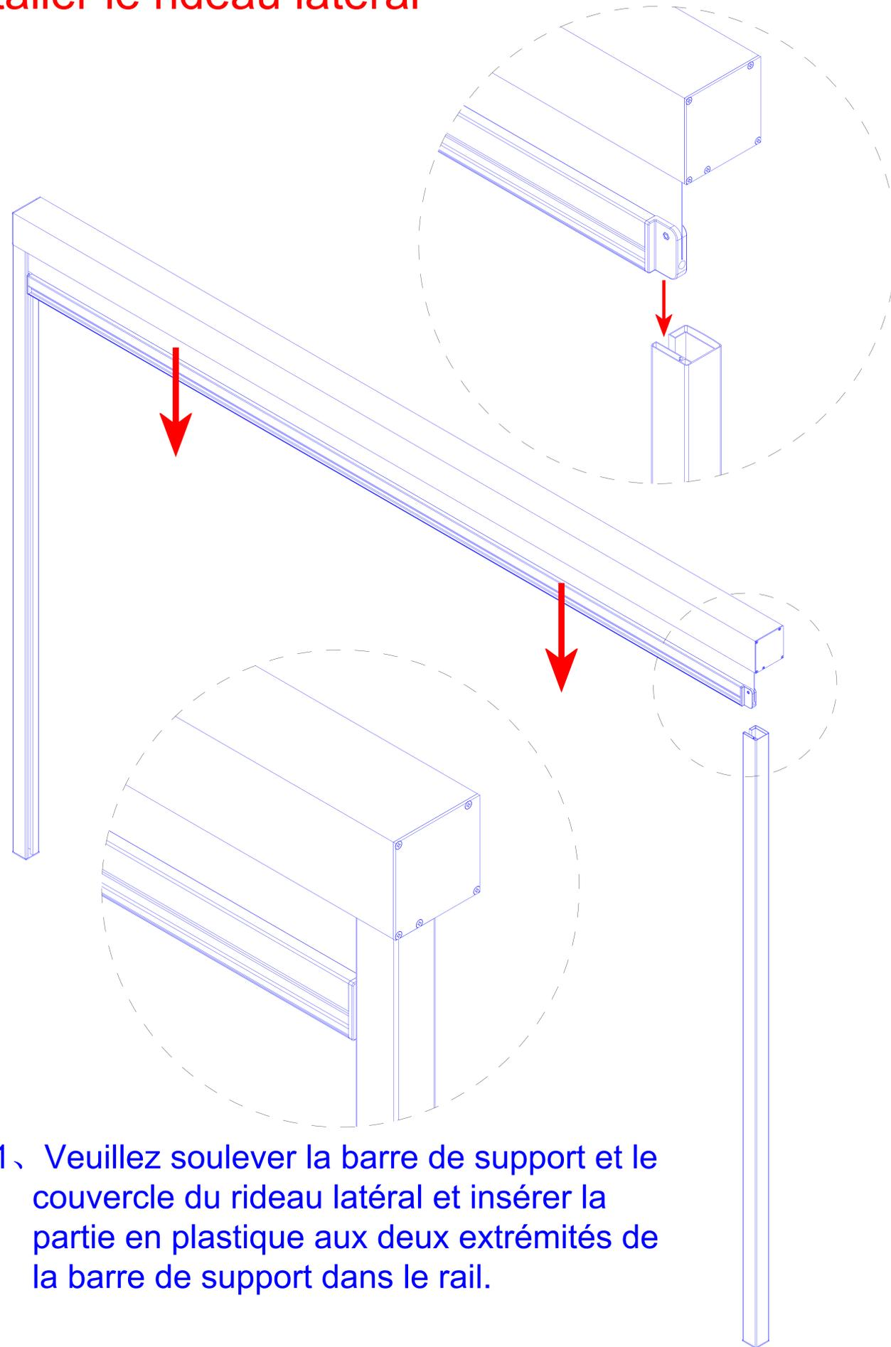
1、 Veuillez soulever la barre de support et le couvercle du rideau latéral et insérer la partie en plastique aux deux extrémités de la barre de support dans le rail.
