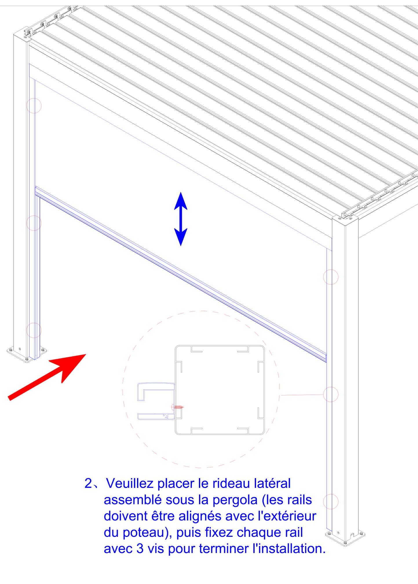
2、 Veuillez placer le rideau latéral assemblé sous la pergola (les rails doivent être alignés avec l'extérieur du poteau), puis fixez chaque rail avec 3 vis pour terminer l'installation.
