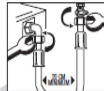
6 Visser l'écrou à la main, côté robinet de gaz et appareil de cuisson jusqu'au contact du joint. Puis, serrez modérément à l'aide d'une clé.
