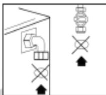
4 S'assurer que les anciens joints, ou morceaux de joint, du côté robinet de gaz et appareil de cuisson ne sont plus en place.
