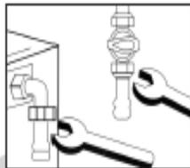
3 Démontez l'about/tétine côté robinet de gaz en le dévissant avec une clé appropriée. Répéter l'opération côté appareil de cuisson.
