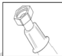
5 Vérifier avant la mise en place que chaque raccord est bien équipé de son joint en bon état.\* APRES UN DEMONTAGE, REMPLACER LES JOINTS
