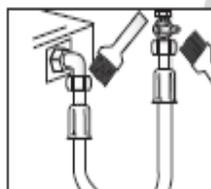
7 Ouvrir le robinet d'arrivée de gaz. Vérifier les étanchéités raccord/appareil de cuisson et raccord/robinet gaz, à l'aide d'un pinceau imprégné d'eau savonneuse ou avec un produit spécifique destiné à cet usage. Si des bulles apparaissent, le raccordement est déficient. Couper immédiatement l'arrivée de gaz. Vérifier votre raccordement. S'assurer lors de la remise en place de l'appareil que le rayon de courbure du flexible n'est pas inférieur à 9 CM.
