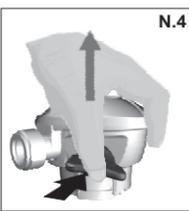
**NOTE - ELEMENT DE SECURITE IMPORTANT:** Il n'est pas possible d'appuyer sur la poignée si le bouton n'est pas en position horizontale complète et l'inscription "OFF" n'est pas visible.
