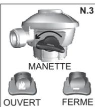
**FERMÉ (OFF):** Le débit de gaz peut être interrompu en tournant le bouton à fond d'un demi-tour dans le sens des aiguilles d'une montre jusqu'à atteindre la position horizontale opposée OFF. La valve est maintenant fermée.
