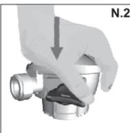
**REMARQUE: Le modèle Quick-On+ est conçu de sorte à pouvoir être monté sur la valve uniquement lorsque la poignée est en position «OFF».**
