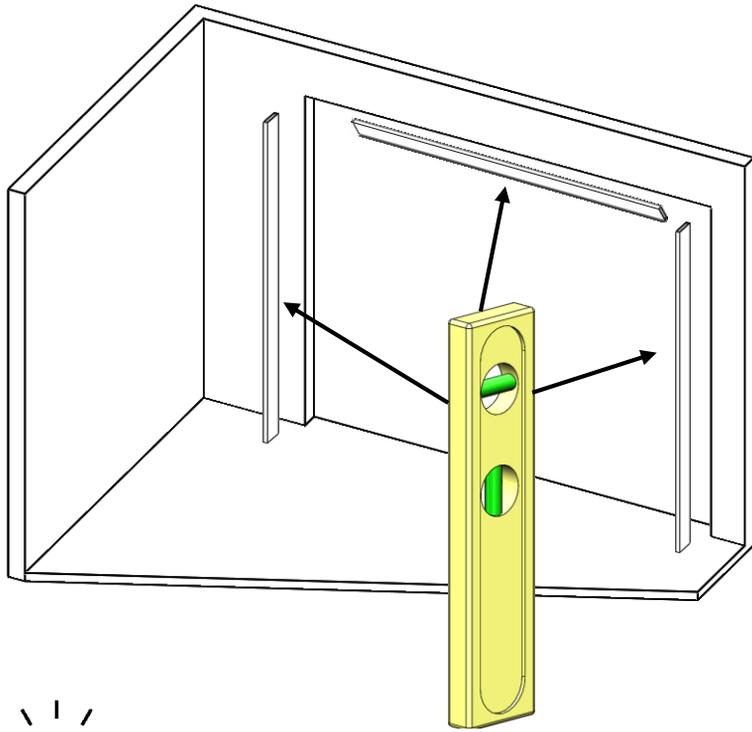
A l'aide d'une règle et d'un niveau, vérifier la rectitude de votre maçonnerie. Vérifier également les diagonales.
