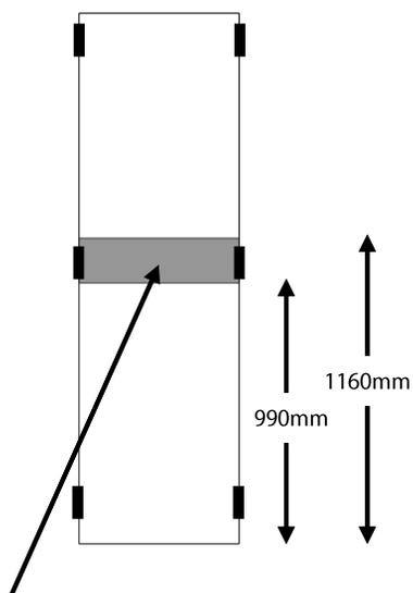
La hauteur de serrure est à choisir au montage. Cependant, la position des broches centrales sur les panneaux interdit une hauteur de poignée entre 990mm et 1160mm depuis le bas du portillon.
