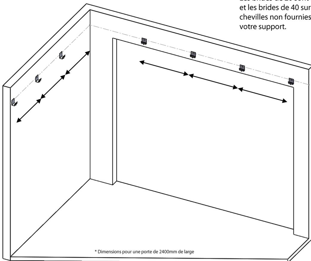
Les brides de 20 sont à poser au niveau de la baie et les brides de 40 sur le mur de refoulement. Les chevilles non fournies doivent être adaptées à votre support.
