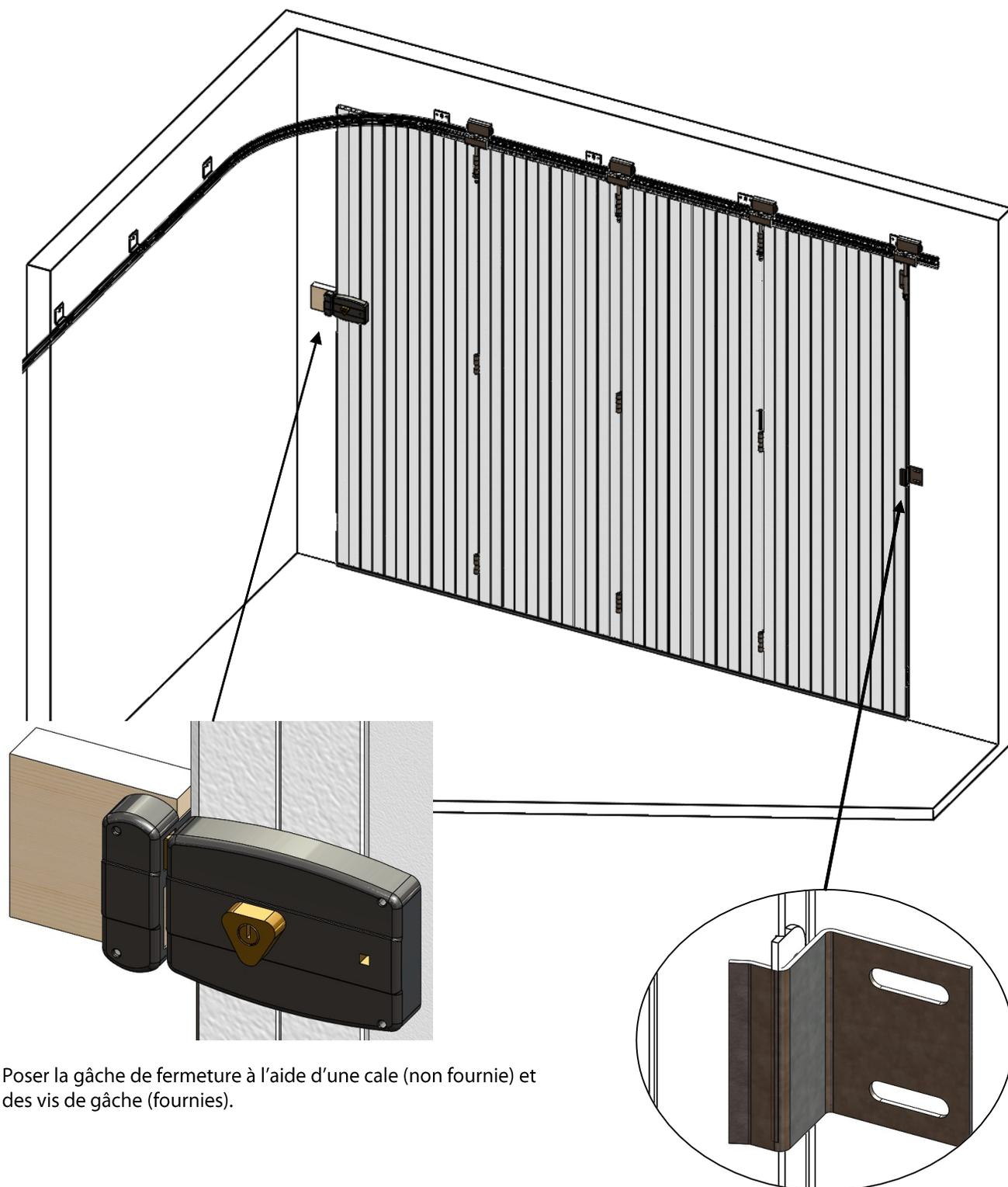
Poser la gâche de fermeture à l'aide d'une cale (non fournie) et des vis de gâche (fournies).
