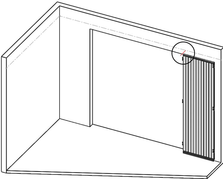
Poser l'un des vantaux au sol et tracer un trait horizontal à 80mm au dessus au niveau de la baie et sur le mur de refoulement.
