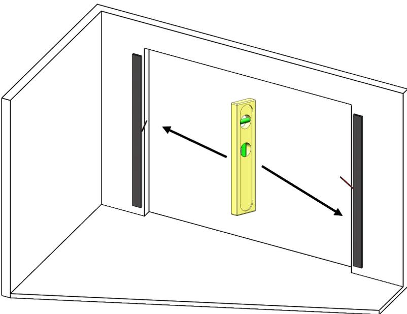
Tracer 2 verticales à 25mm de chaque côté du tableau. Ces traits serviront à préréglage votre porte. Si le tableau ne fait pas 2400mm de large, l'entraxe entre ces traits doit être de 2450mm. Répartir alors équitablement.
