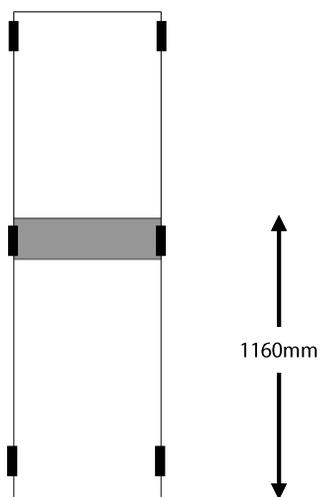
La serrure est à monter sur le portillon. La position est déterminée par les entailles prévues sur le vantail secondaire (axe à 1155mm du bas du vantail).
