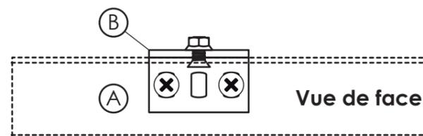
Le rail est écarté au maximum du mur.
