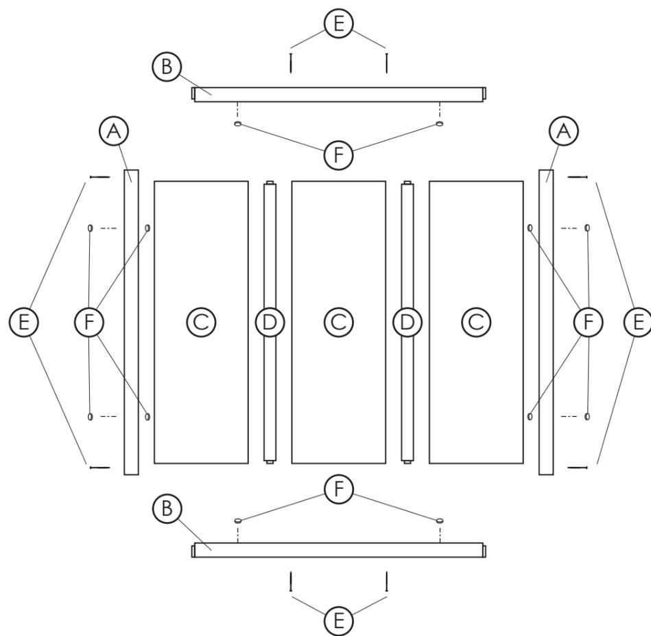
Dépoussiérer, peindre et laisser sécher les pièces en bois (A) (B) et (D) avant d'assembler la verrière. Veiller à ne pas combler les rainures.
