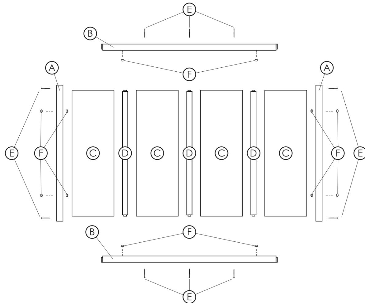
Dépoussiérer, peindre et laisser sécher les pièces en bois (A) (B) et (D) avant d'assembler la verrière. Veiller à ne pas combler les rainures.
