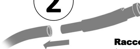
**Raccorder le tuyau flexible à la tuyauterie d'évacuation**
