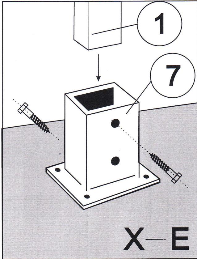
La visserie pour la fixation des platines sur le béton n'est pas fournie
