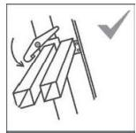
I dispositivi di bloccaggio devono essere completamente bloccati
