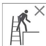
Ne pas descendre de l'échelle par le côté pour rejoindre une autre surface
