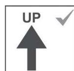
Utiliser l'échelle dans la direction indiquée par le fabricant
