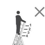
Ne pas monter au-dessus des 4 échelons supérieurs
