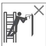
Evite trabajos que impongan una carga lateral en las escaleras, como la perforación lateral a través de materiales sólidos
