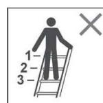
Ne pas se tenir sur les 3 échelons supérieurs d'une échelle d'appui
