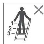
Non stare sui primi 3 pioli/gradini di una scala singola d'appoggio
