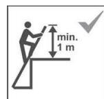
Pour accéder à un niveau supérieur, l'échelle doit dépasser d'au moins 1 mètre le point d'appui
