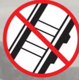
Positionnement interdit : les échelons ne doivent pas être en contact avec le toit
