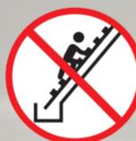
Ne pas reposer l'échelle sur la gouttière
