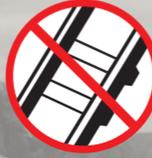
Positionnement interdit : les échelons ne doivent pas être en contact avec le toit
