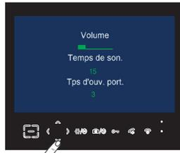
Appuyer sur les flèches pour choisir le volume, la durée de la sonnerie & le temps d'ouverture du portail.
