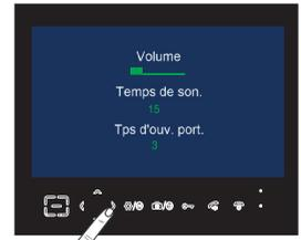
Appuyer à gauche ou à droite pour ajuster le volume, la durée de la sonnerie (1-15 secondes) & le temps d'ouverture (1-9 secondes).
